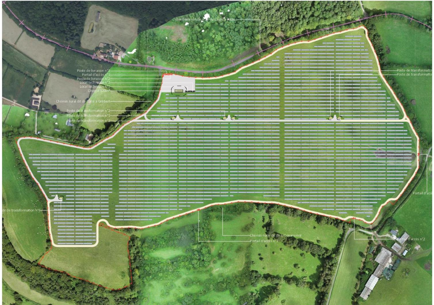
\*Le taux de couverture est calculé à la surface projetée des panneaux. Si on le rapporte à la surface clôturée de la parcelle, il est de 28,5 %.
