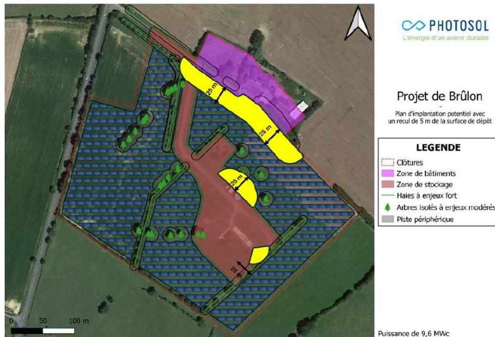
Figure 13 : Implantation envisagée pour le projet d'installation photovoltaïque avec prise en compte des distances de séparation
